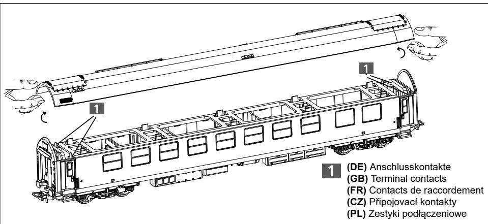
**(DE) Montage Radschleifer Y-Salonwagen • (GB) Installation of wheel pick-up shoes • (FR) Montage des frotteurs d'essieux • (CZ) Montáž kartáčů kol • (PL) Montaż ślimaczek**
